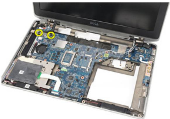
**16.** Extraiga el soporte del cable de la pantalla del equipo.
