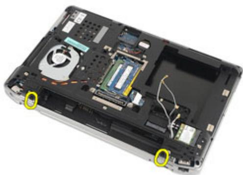
14. Saque los cables de la antena de las canaletas.
