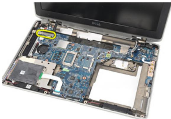
**17.** Tire del cable de la pantalla para desconectarlo de la placa base.
