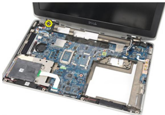
19. Extraiga el ensamblaje de la pantalla del equipo.
