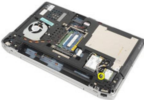
7. Extraiga la tarjeta WLAN de su ranura en la placa base.
