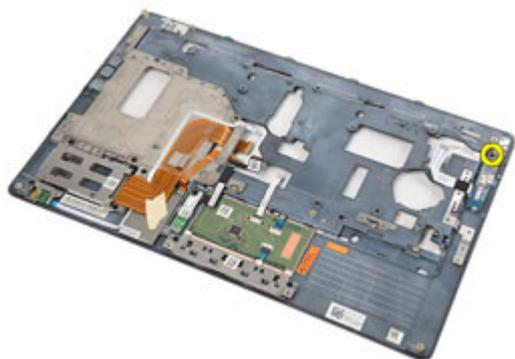
**13.** Extraiga la placa de LED del ensamblaje del reposamanos.
