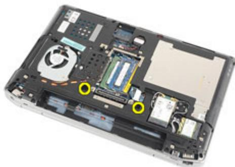
5. Extraiga los tornillos que fijan el teclado al ensamblaje del reposamanos.
