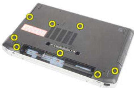
5. Levante la cubierta para extraerla del equipo.
