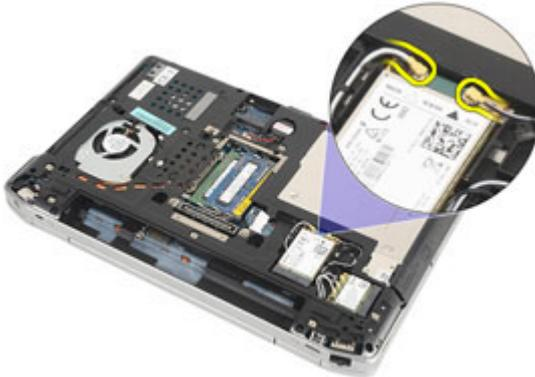
6. Extraiga el tornillo que fija la tarjeta WWAN al equipo.
