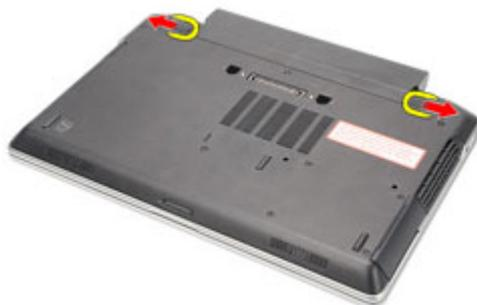
3. Deslice la batería hacia afuera y extráigala del equipo.
