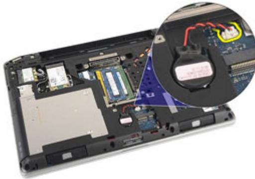
6. Levante y retire la batería del adhesivo.
