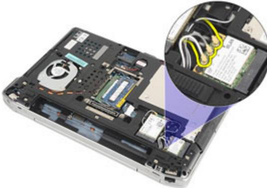
6. Extraiga el tornillo que fija la tarjeta WLAN al equipo.
