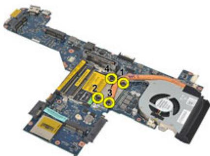
21. Extraiga el ensamblaje del disipador de calor de la placa base.
