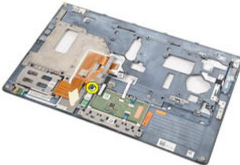
12. Extraiga la tarjeta bluetooth del ensamblaje del reposamanos.
