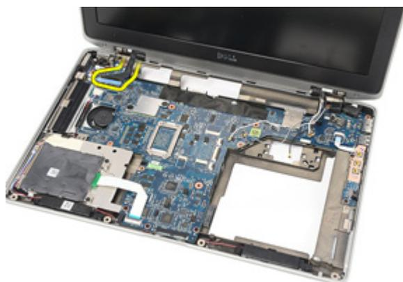
**18.** Extraiga el tornillo que fija el ensamblaje de la pantalla al equipo.
