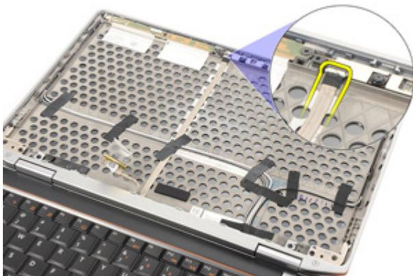
6. Extraiga el tornillo que fija la cámara y el micrófono al ensamblaje de la pantalla.
